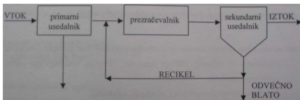
Slika 1: Shema biološkega čiščenja z aktivnim blatom
