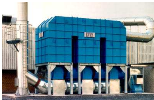
Slika 15: Čistilni napravi, ki delujeta na principu termičnega zgorevanja
