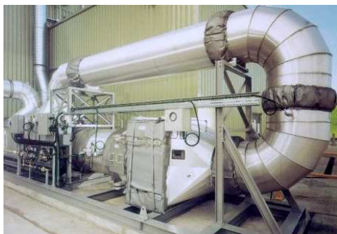
Slika 15: Čistilni napravi, ki delujeta na principu termičnega zgorevanja
