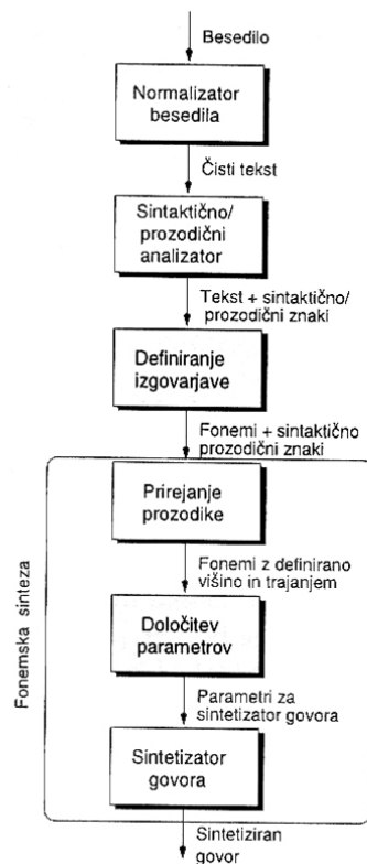
Slika 2: Shema sistema pretvorbe besedila v govor
