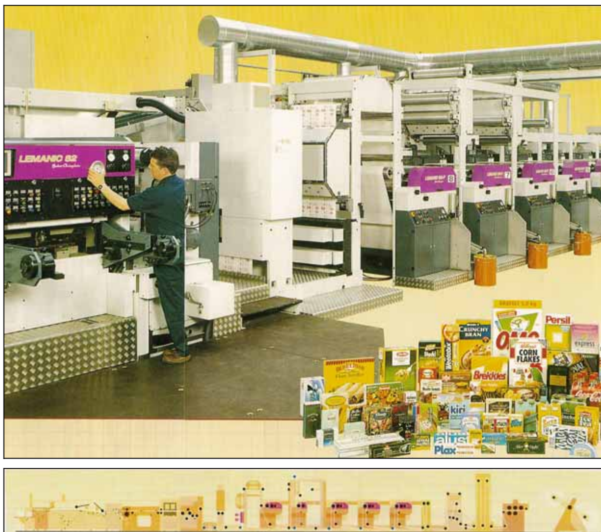
Slika 3: Primer stroja za fleksotisk – Lemanic 82 F (Bobst – Champlain).
