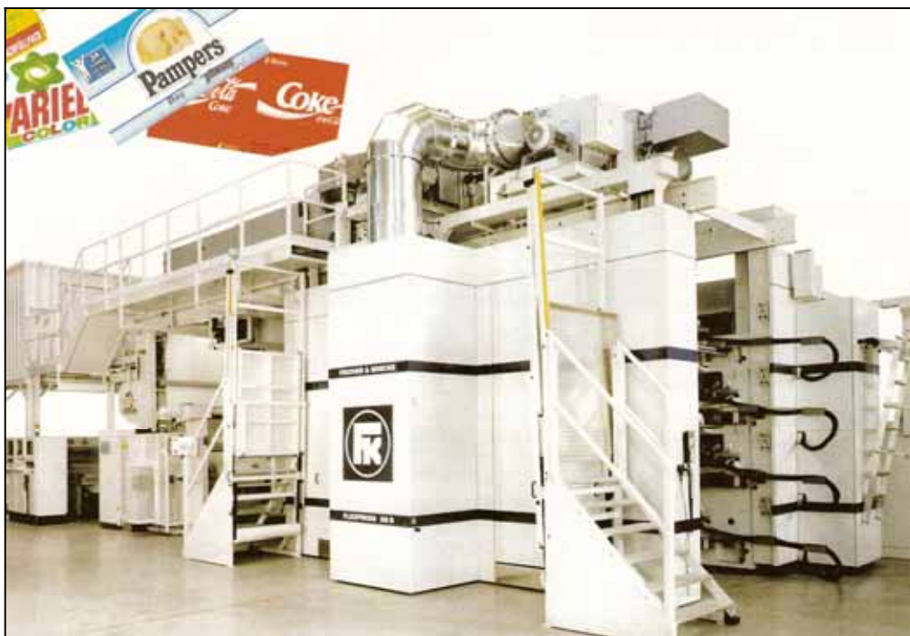
Slika 24: Tiskarski stroj FISHCER & KRECKE FLEXPRESS 26 S za osem- ali desetbarvni tisk s sistemom Sleeve in servo pogonom na centralnem cilindru.
