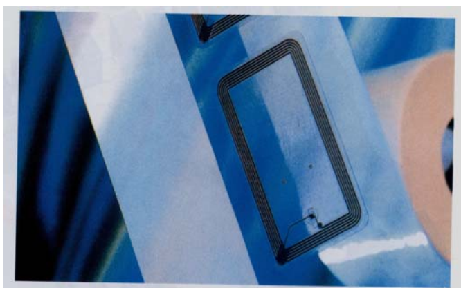
Slika 21: Pametna kartica vsebuje mikročip in malo anteno na hrbtni strani
