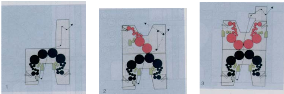
Slika 10: Skice horizontalne postavitve gumi valjev v obliki loka (1), črke Y (2) in črke H (3)
